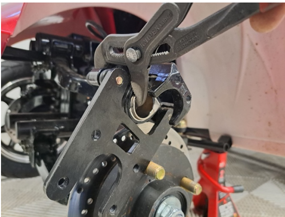
Paina etujarru mäntä sisään, että uudet etujarrupalat mahtuvat paikoilleen.
