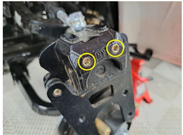
Irrota etujarrupalojen kiinnitystapit. (kuusiokoloavain 4 mm).
